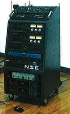
オートミキサー [EVOLUTION3] スポーツクラブでの使用を考えた開発された、エアロビクス専用ミキサー。スイッチを押すだけで2種類の音楽ソースを自動的にクロスカットでき、さらに、カセットデッキのスタート、ストップも自動でできます。また、モニター用のスピーカーがついているので演出も簡単。足元で操作できるフットスイッチもあり、インストラクターの片手となる完成度の高いマシンです。さらに改良をかき入れたバージョン4も12月に発売予定です。
